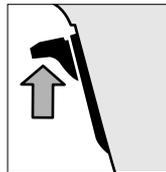
Для **фиксирования** нажатого выключателя **6** сдвиньте кнопку фиксирования **5** вверх.
