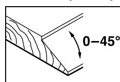
Настройте нужный угол скашивания четверти и поверхности с помощью гайки настройки угла **22**.
