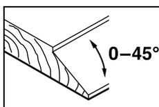
Настройте нужный угол скашивания четверти и поверхности с помощью гайки настройки угла **25**.
