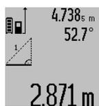
По окончании измерения результат для искомого отрезка «Х» отображается в строке результата **с**. Значения измерения для отрезка «1» и угла «α» отображаются в строках измеренных значений **а**.
