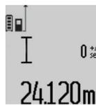
После окончания заданного временного интервала измерение выполняется автоматически.
