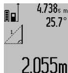
По окончании измерения результат для искомого отрезка «**X**» отображается в строке результата **с**. Значения измерения для отрезка «**1**» и угла «**α**» отображаются в строках измеренных значений **а**.
