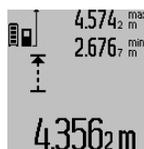
В строке результата **с** будет отображаться текущее значение измерения. В строках измеренных значений **а** отображаются максимальное («**max**») и минимальное («**min**») измеренное значение. Они постоянно обновляются, если текущее значение длины будет меньшим/большим чем предыдущее
