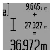
Для опрашивания суммы обоих измерений нажмите кнопку результата **5**. Расчет суммы отображается в строках измеренных значений **a**, сумма отображается в строке результата **c**.
