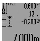
В общем отрезке длиной 7,0 м не хватает 0,2 м, чтобы значение разметки, составляющее 0,6 м, поместилось в нем 12 раз. Увеличите расстояние между измерительным инструментом и исходной точкой на 0,2 м и перенесите длину.
