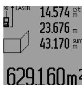
Измерьте теперь длину **B<sub>2</sub>** второй стены. Отображаемое в средней строке измеренных значений **a** значение прибавляется к длине **B<sub>1</sub>**. Сумма обоих значений длины («**sum**»), которая отображается в нижней строке измеренных значений **a**), умножается на сохраненное в памяти значение высоты **A**. Значение общей площади стен отображается в строке результата **c**.
