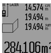
Затем измерьте длину **B<sub>1</sub>** первой стены. Площадь рассчитывается автоматически и отображается в строке результата **c**. Значение длины появляется в средней строке измеренных значений **a**. Лазер остается включенным.
