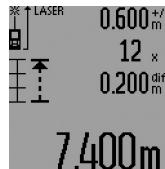
В общем отрезке длиной 7,4 м значение разметки, составляющее 0,6 м, содержится 12 раз. Кроме того, общий отрезок содержит еще остаток длиной 0,2 м. Сократите расстояние между измерительным инструментом и исходной точкой на 0,2 м и перенесите затем длину.
