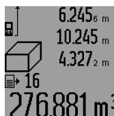
Чтобы вызвать сохраненные в памяти значения измерений, нажмите кнопку **15**. На дисплее отображается результат последнего измерения и индикатор списка измеренных значений **d**, а также счетчик с нумерацией измерений, отображаемых на дисплее.
