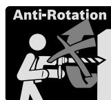
С целью ограничения высоких реактивных моментов электроинструмент оснащен предохранительной муфтой (Anti-Rotation).
