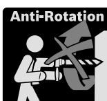
С целью ограничения высоких реакционных моментов электроинструмент оснащен предохранительной муфтой (Anti-Rotation).
