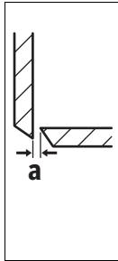
Расстояние между ножами **a** (зазор между режущими кромками) зависит от толщины обрабатываемого листового материала  $d_{\max}$ .
