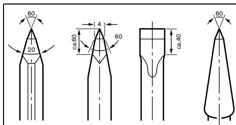
Для **ковки** нагревайте долбежный инструмент до температуры от 850 до 1050 °C (светлокрасный до желтого).
